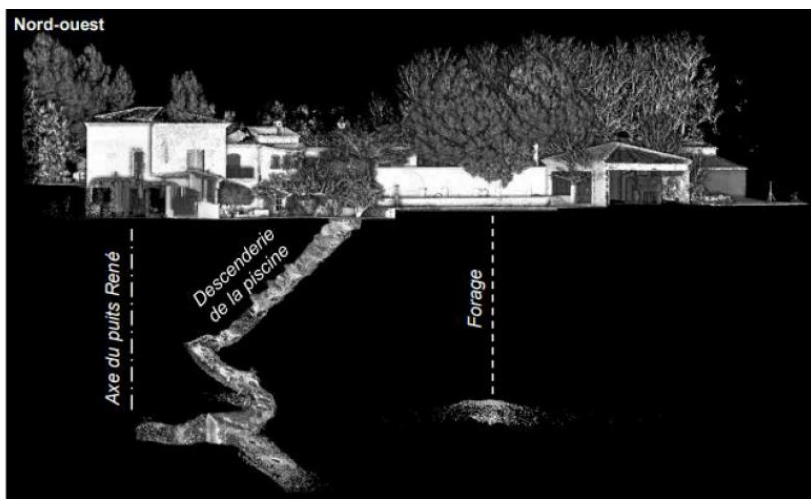
Illustration 33 : Vue en perspective du relevé de la surface et des travaux souterrains (dirigé vers le nord-est) – 13 (doc. GEODERIS).
