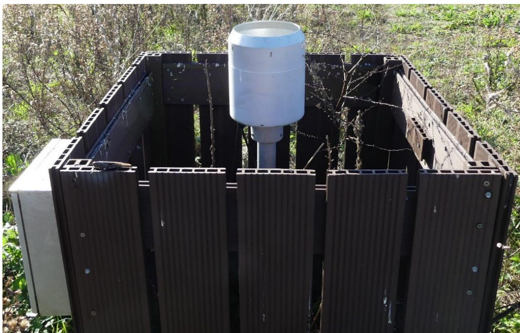
Illustration 28 : Pluviomètre enregistreur installé sur le dépôt du Lenté – Fontsante – Tanneron (83).
