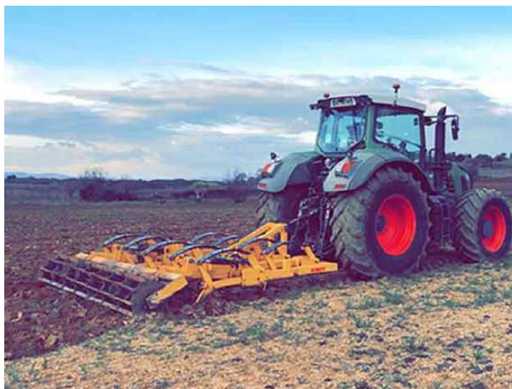
Passage du chisel
