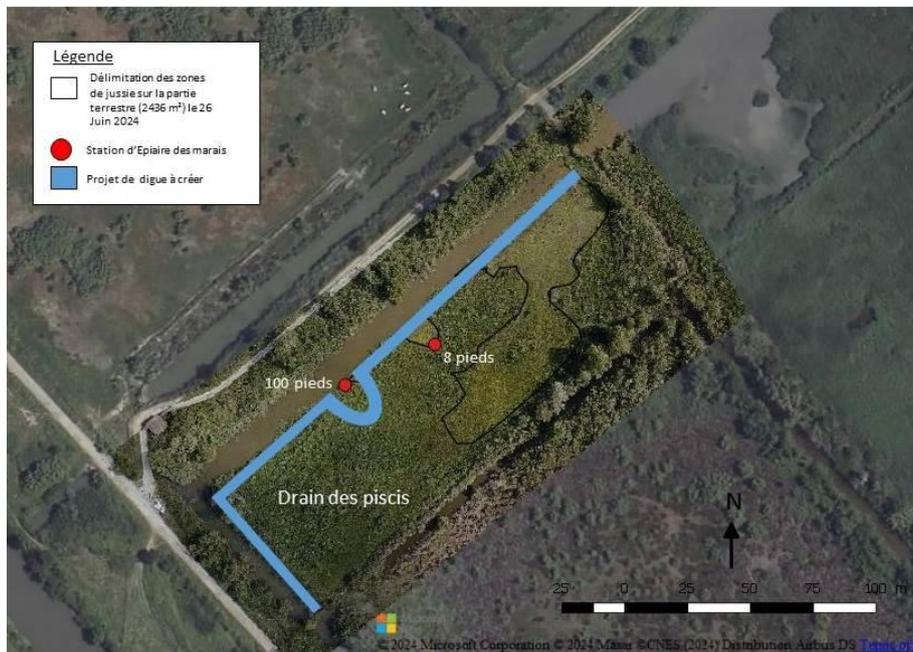
**Figure 9 : Schématisation du contournement de la station d'Epière des marais par déviation légère de la trajectoire de la diguette prévue dans le Drain des Piscis**
