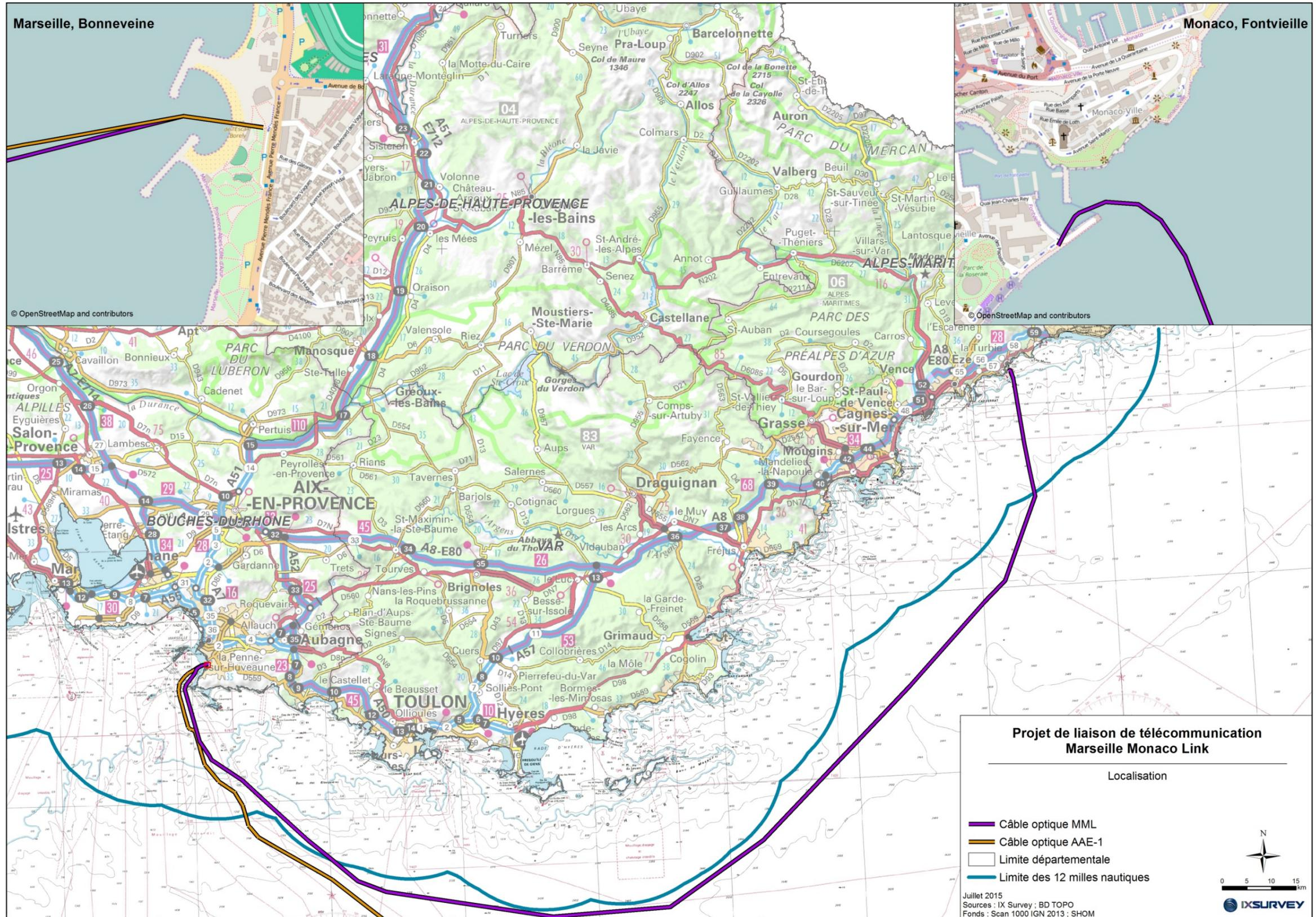
FIGURE 2 - Emprise globale de la route des câbles MML et AAE-1 proposées au départ de Marseille (plage de Bonneveine).
