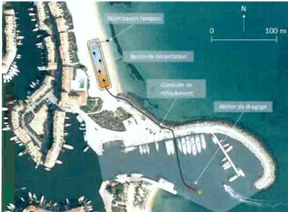
Figure 12 : Description des travaux de dragage et de gestion des sables de Port Grimaud 1 (rechargement de plage)
