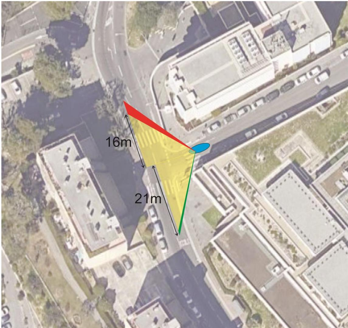
Figure 37. Schéma des triangles de visibilité du cédez-le-passage
