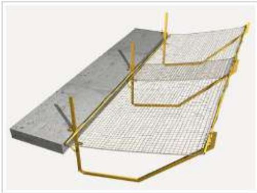
Ce dispositif de retenue sera à dimensionner pour reprendre les charges dynamiques de la chute d'objets (plinthes ou autres, ...) ou de personnes.
