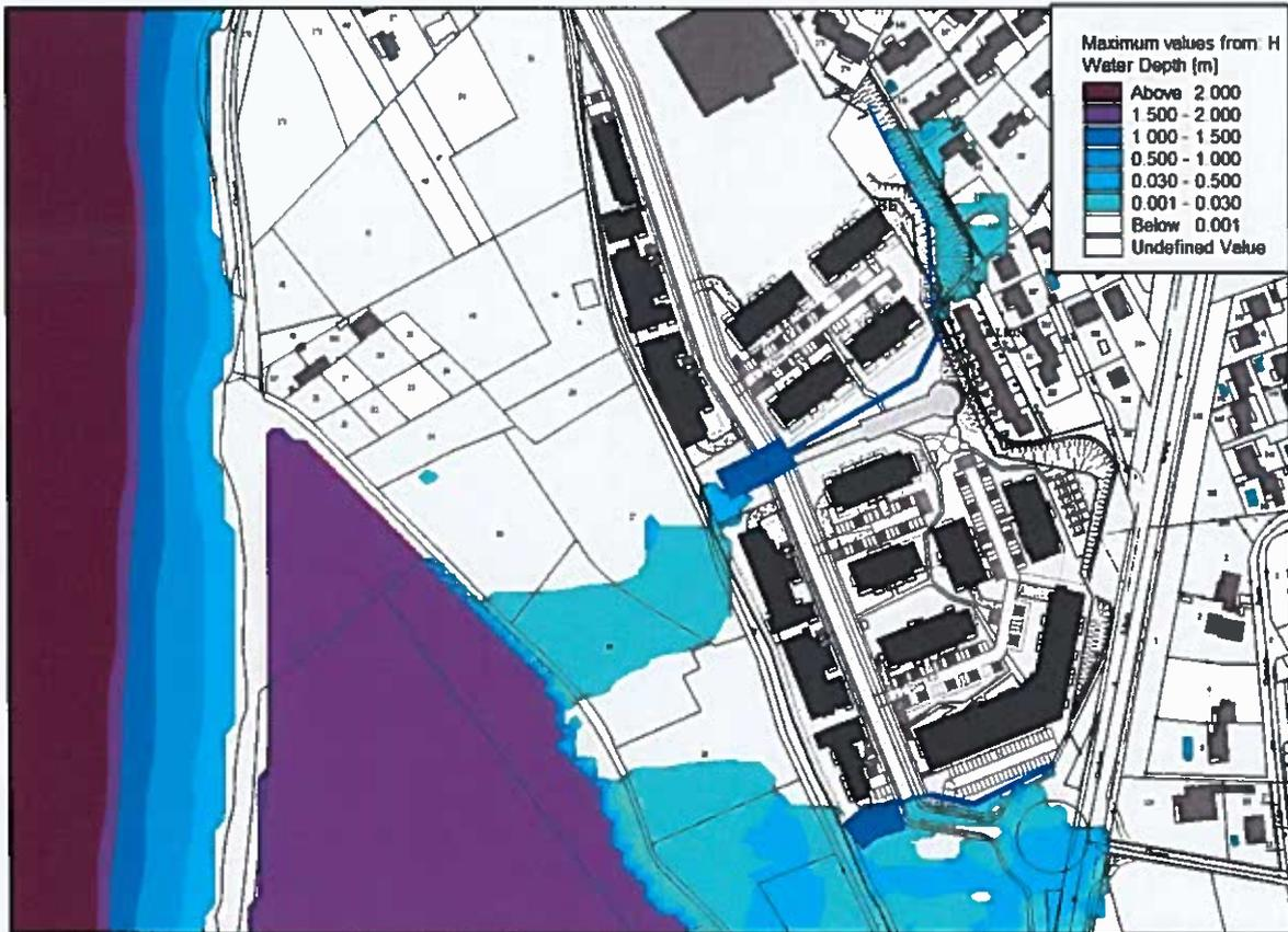
Figure 13 : Cartographie des hauteurs d'eau maximales en crue centennale (Etat projet)
