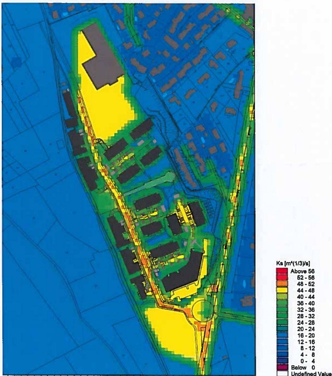
Figure 20 : Modèle de rugosité modifié en situation après aménagements
