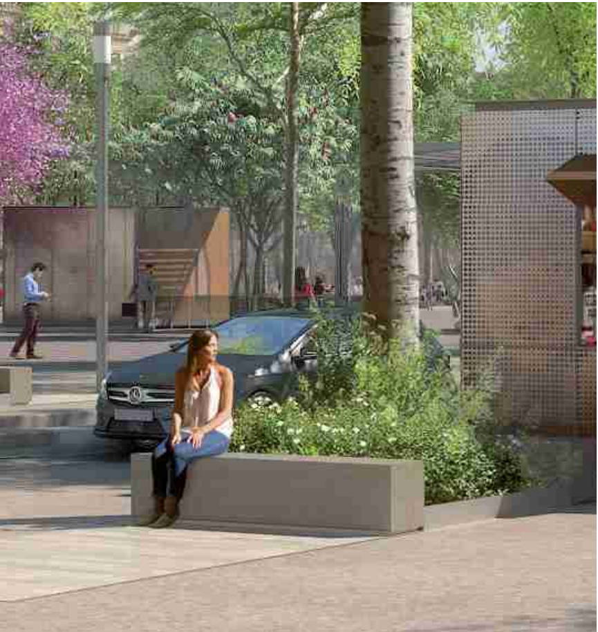
Dalles de pierre calcaire en « bande à courir » alternance de 2 teintes gris-sable claire et foncée largeur 10 cm / longueur comprise entre 30 et 80 cm
