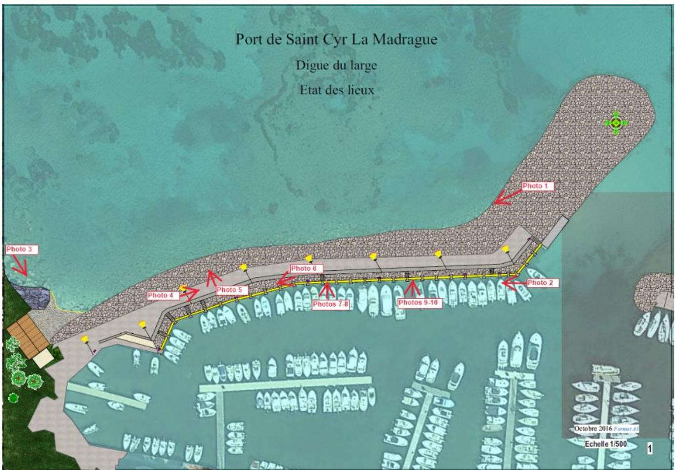
Trois zones distinctes peuvent être définies sur la digue du port de la Madrague : Côté large, la carapace de cet ouvrage, ancien, montre un tassement généralisé, sur l'ensemble du linéaire, réduisant de fait la protection vis-à-vis des franchissements.
