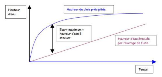
Il s'agit de stocker le volume maximal entre le volume ruisselé sur la zone d'étude et le volume évacué par le débit de fuite, à la durée de pluie la plus « pénalisante ».
