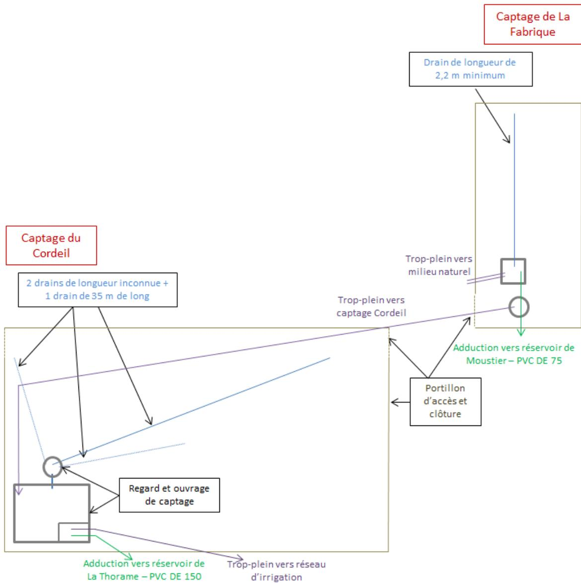
**Photo 1 : Vue schématique des captages (dessin non à l'échelle)**
