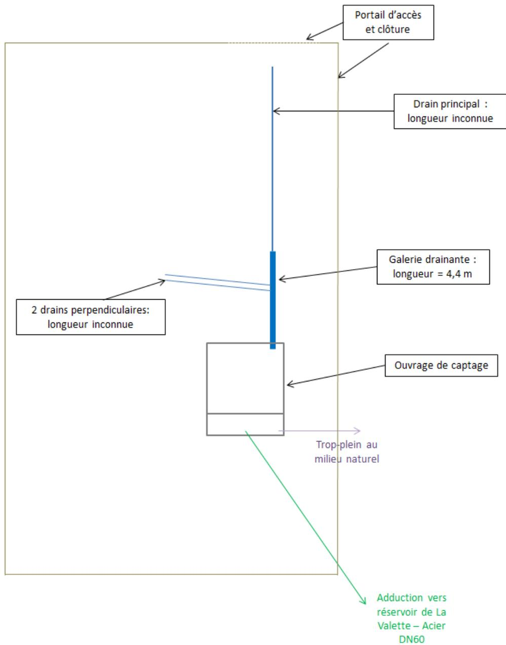
**Photo 9 : Coupe schématique interprétative du captage de La Combe (dessin non à l'échelle)**
