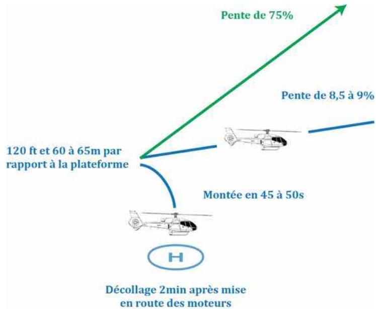
Figure 6 : Décomposition des phases d'approche au décollage
