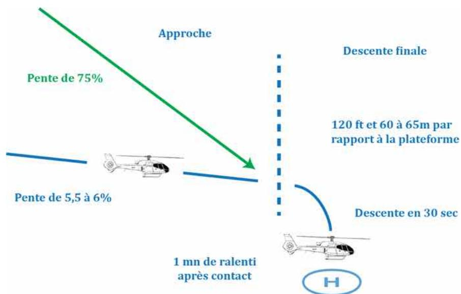
Figure 5 : Décomposition des phases d'approche à l'atterrissage
