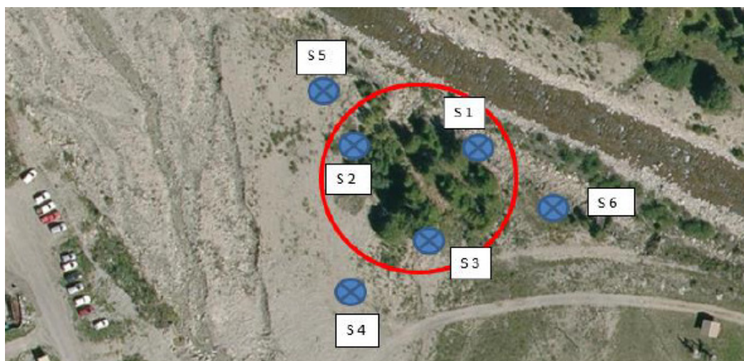
Localisation des sondages à la pelle mécanique – identification de la présence éventuelle d'une ancienne décharge
