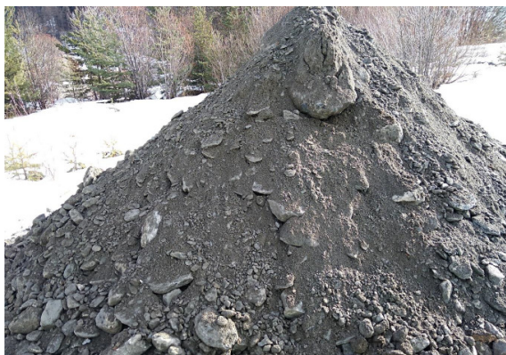
Photo des déblais issus du sondage n°4
