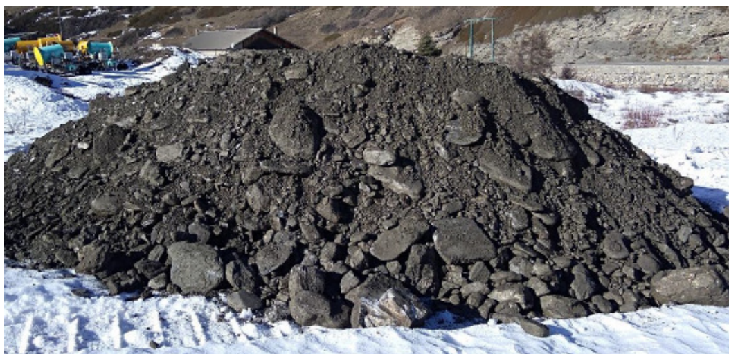
Photo des déblais issus du sondage n°4
