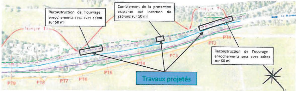
Figure 1 : Projet de tracé dans la zone amont du périmètre de travaux (source : étude de dangers 2018 du RTM05)
