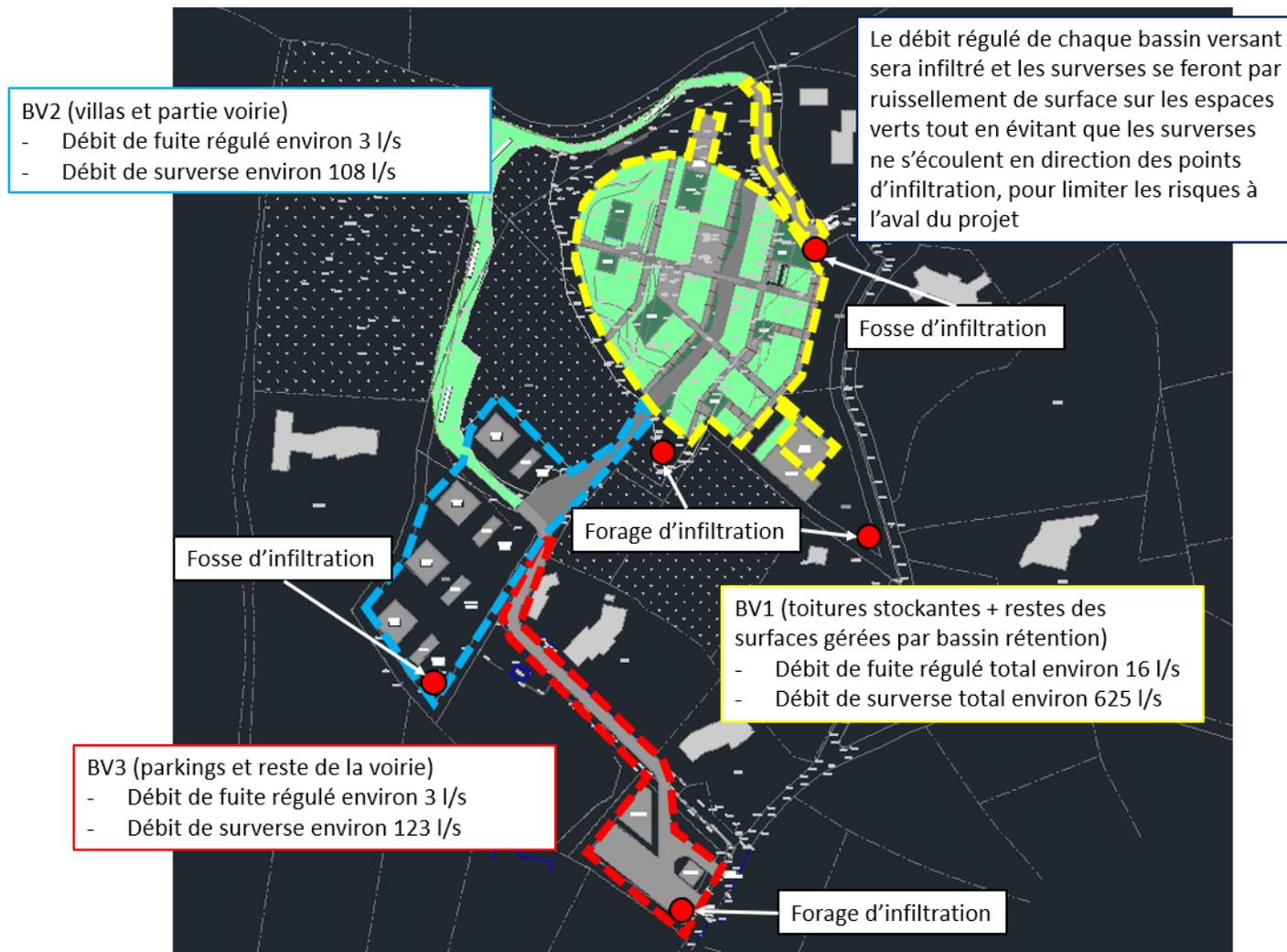
Figure 3 : Gestion des écoulements du projet par bassin versant
