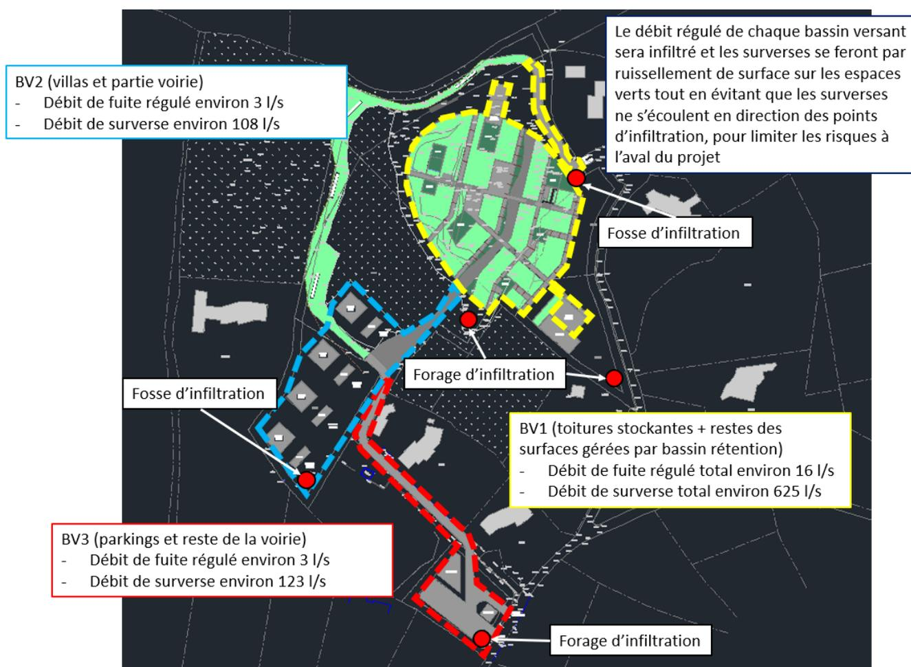
Illustration 9 : Schéma de gestion des écoulements du projet par bassin versant – Notice hydraulique CEREG, octobre 2020
