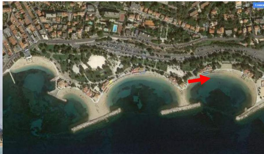
Photos représentatives des pertes en matériaux lors des tempêtes hivernales. Ces matériaux sont remis sur la plage mais il y a des pertes nécessitant des rechargements en période estivale.
