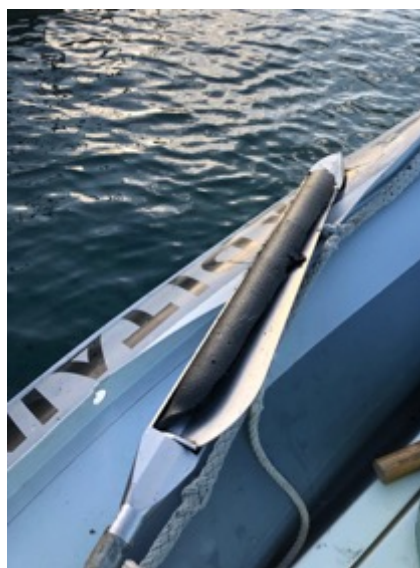
Figure 2 : Carottier à lame (sédiments station E3)
