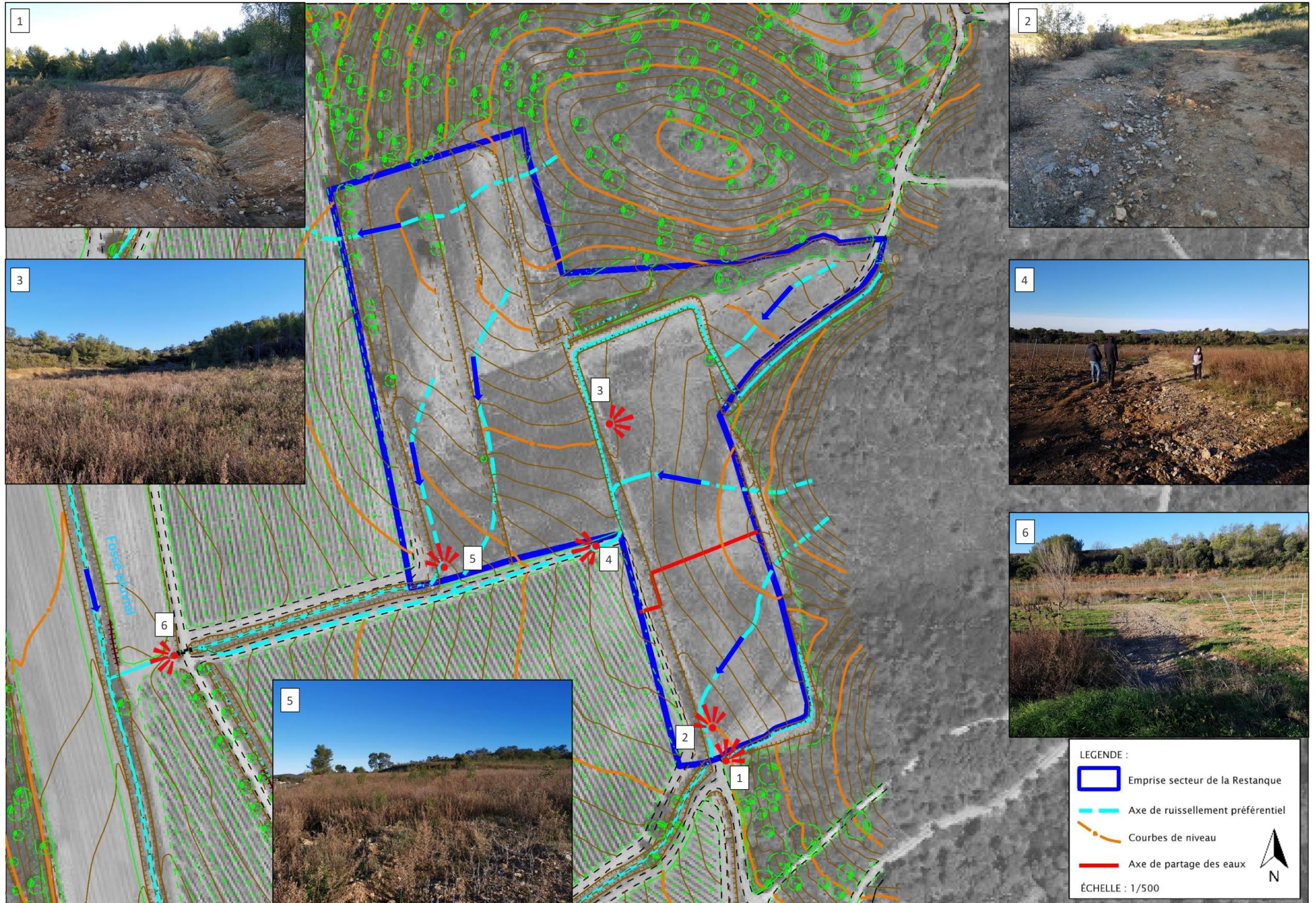
Analyse hydraulique du secteur « Les Restanques »
