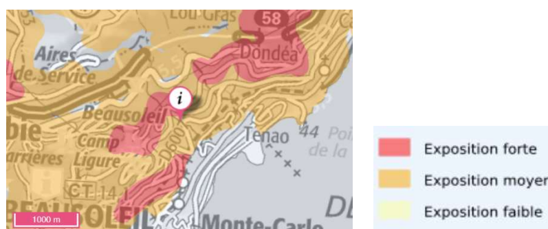
Figure 7 : Exposition du site aux retrait-gonflements des sols argileux
