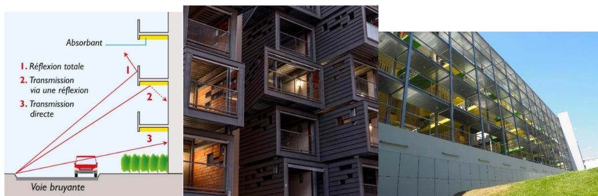
Schéma et exemple de balcons et de coursives permettant de diminuer l'impact du bruit
