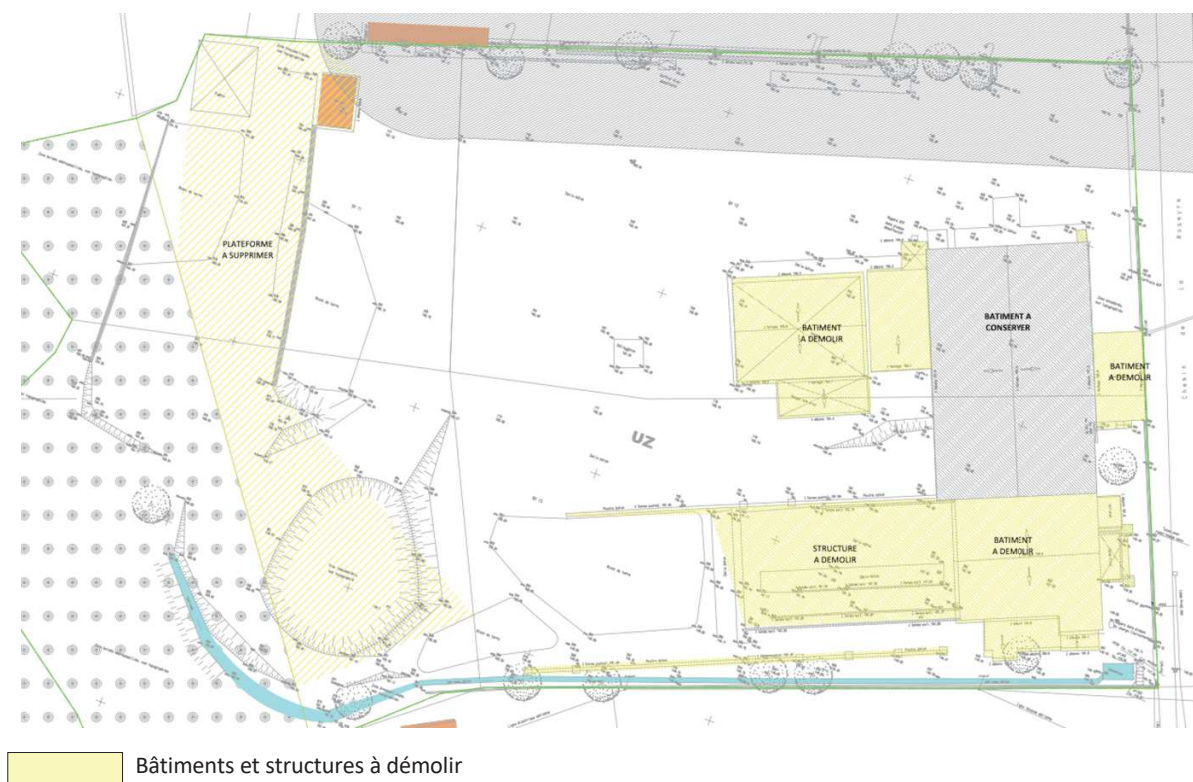
Figure 6 : Plan des démolitions
