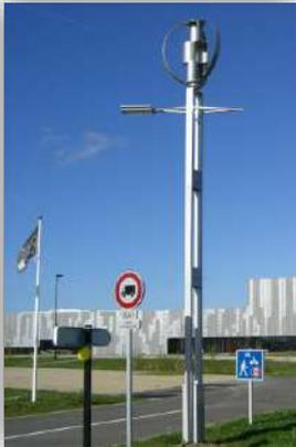
Une éolienne de type mixte (Darrieus / Savonius) pour l'éclairage public, de diamètre 1,4 m et d'une hauteur de 1,5 m sera en mesure de produire environ 750 kWh/an.
