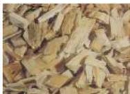
Les **combustibles** utilisés sont les sous-produits forestiers (branchages, petits bois, etc.) et industriels (écorces, sciures, copeaux, etc.) qui sont valorisés sous différentes formes. Pour un réseau de chaleur, étant donnée la puissance de la chaudière bois, on utilise des plaquettes. Les **plaquettes** (ou bois déchiqueté) sont obtenues par déchiquetage d'arbres, de branches, de sous-produits de l'industrie du bois, etc.
