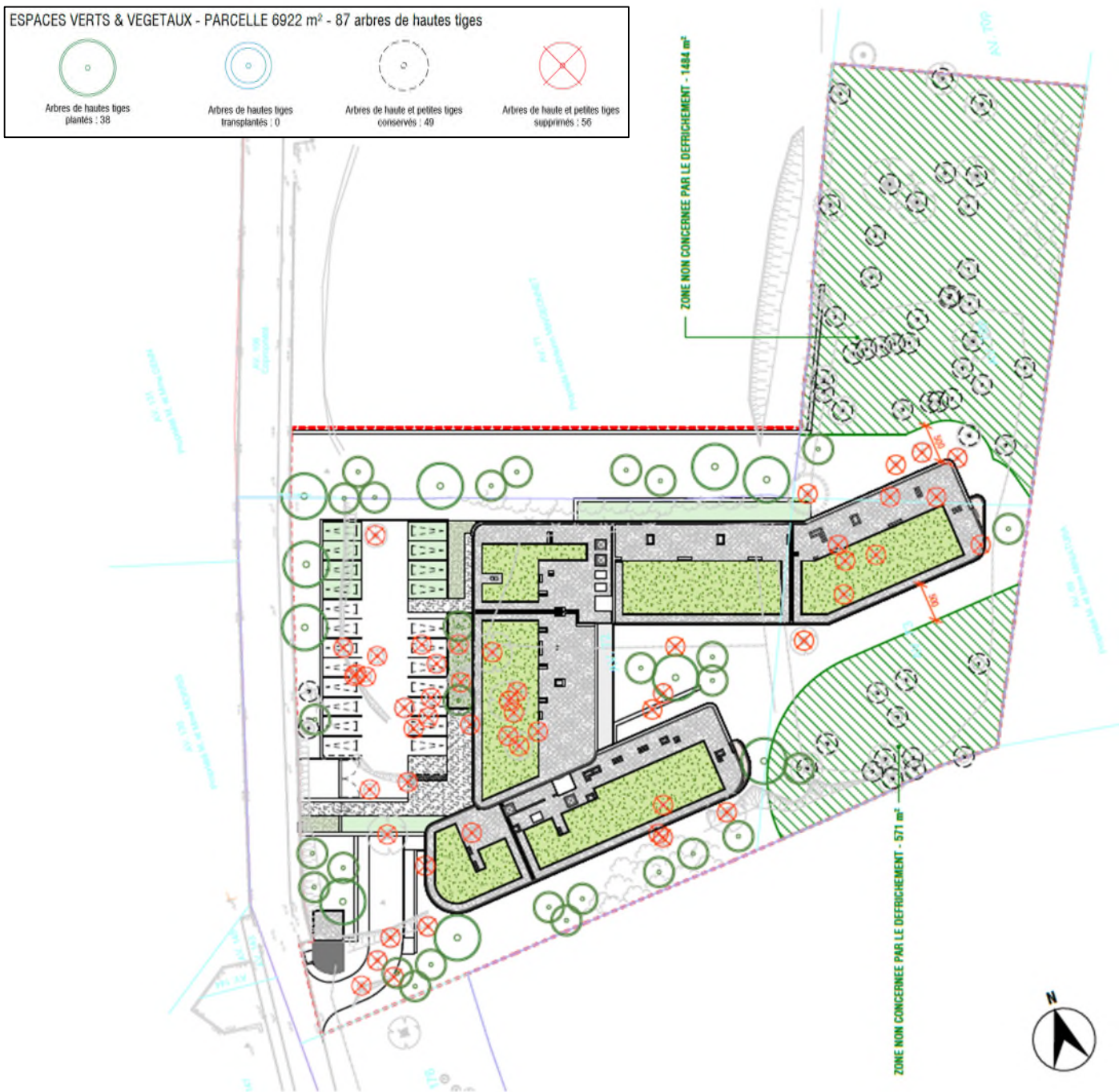
Figure 7 : Plan de masse paysager du projet. Les arbres indiqués en rouge seront retirés, les arbres indiqués en noir seront conservés. Une quarantaine d’arbres de haute tige seront par ailleurs plantés. En vert hachuré, les zones préservées du défrichement.
