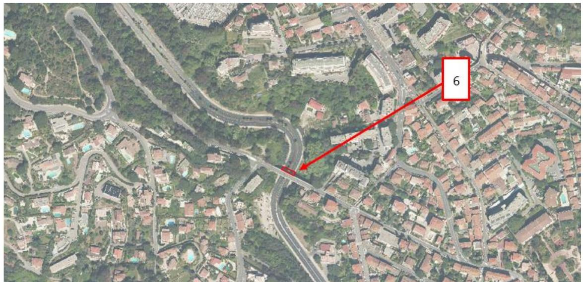
Une grande partie des débordements provenant de l'amont transite sur le boulevard du Riou qui est situé en fond de vallon. Lors d'une crue, les eaux peuvent atteindre des vitesses importantes sur ce secteur, il est donc nécessaire d'implanter un système d'alerte et de fermeture du boulevard en cas de crue importante (action 3-3).
