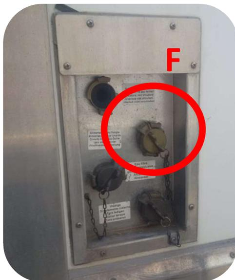
5. Arrêter le remplissage lorsque la bille de témoin est positionnée au max
