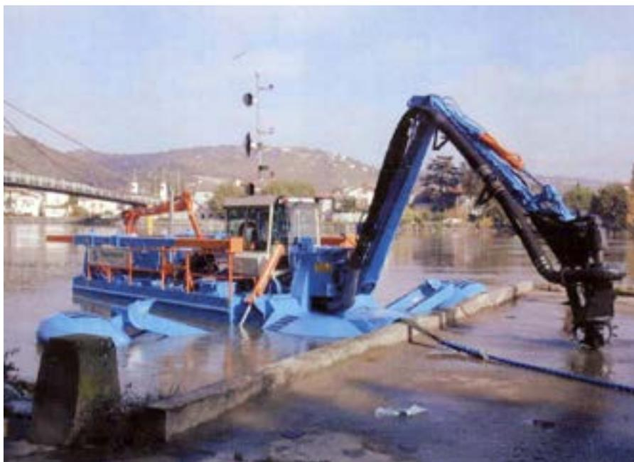
**FIGURE 6 : DRAGUE MULTISERVICE ASPIRATRICE (SOURCE VCMF)**
