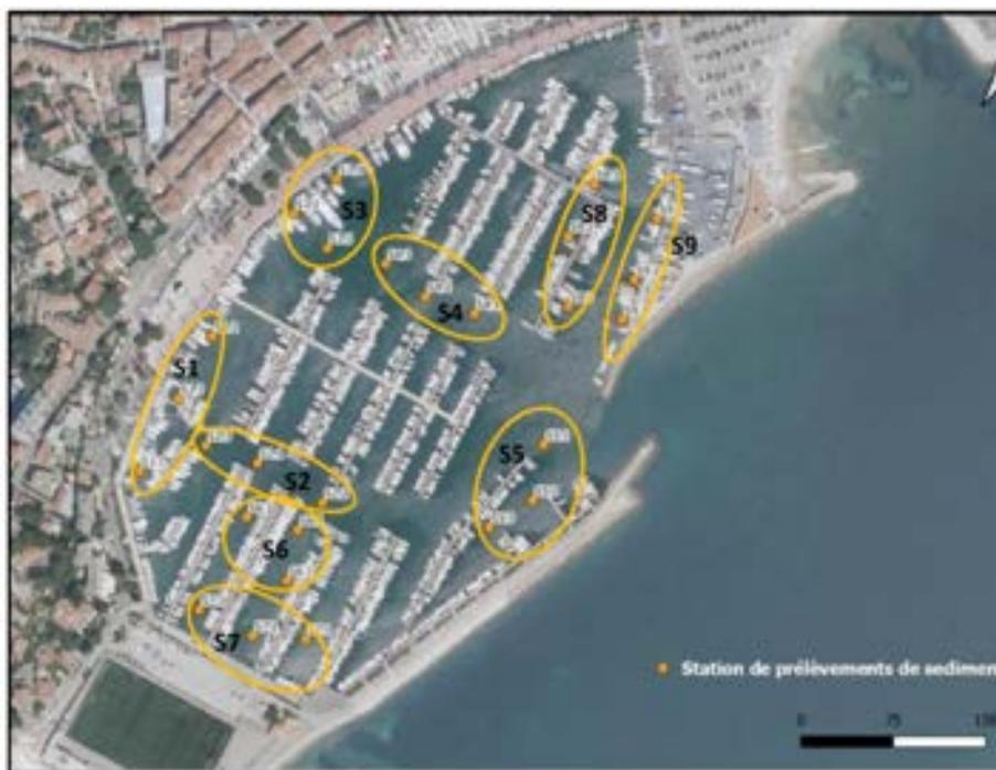
FIGURE 24 : PLAN D'ÉCHANTILLONNAGE DES ÉCHANTILLONS SÉDIMENTAIRES (SOURCE GALATEA 2023)
