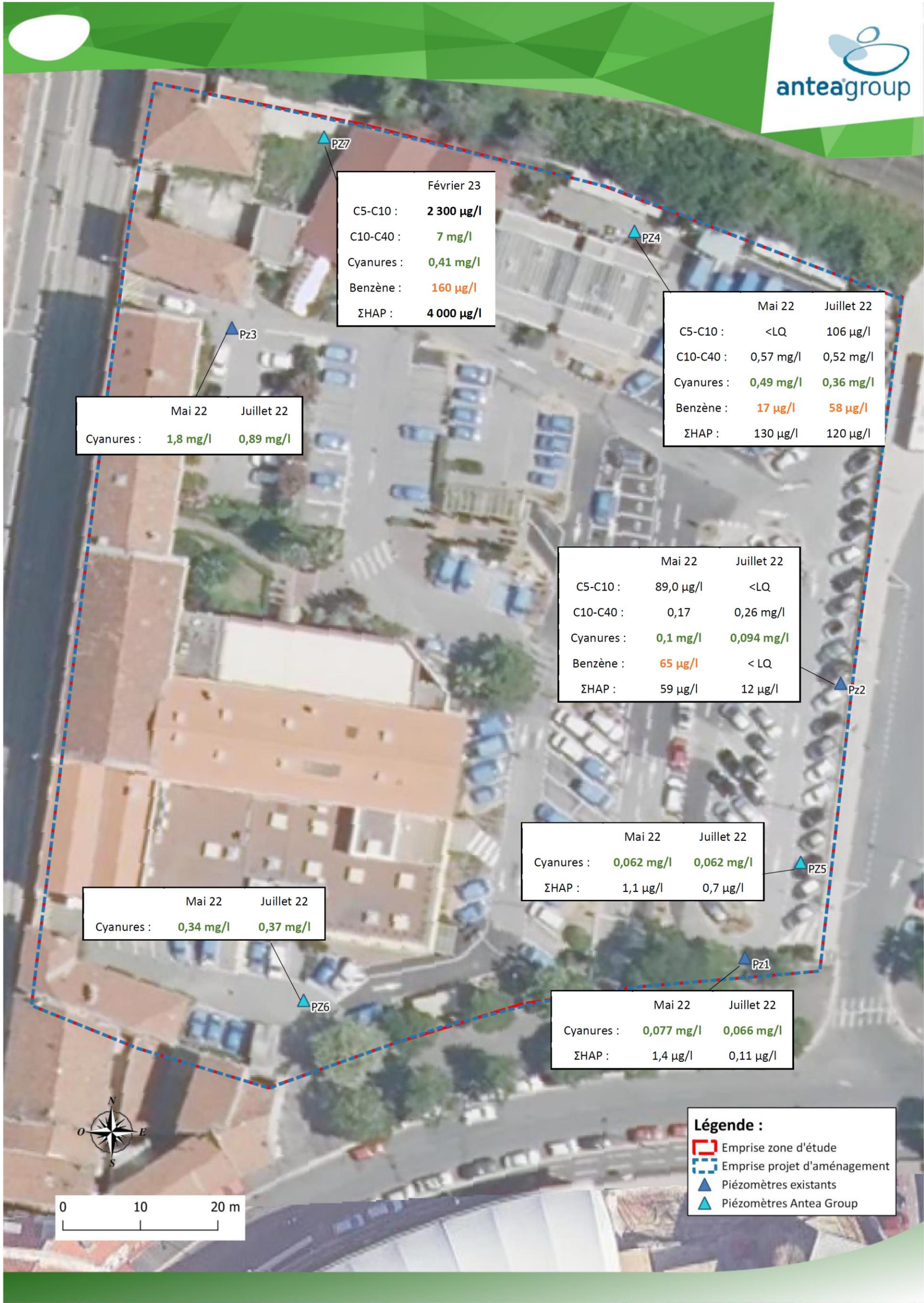
Figure 32 : Cartographie des teneurs quantifiées dans les eaux souterraines – mai et juillet 2022
