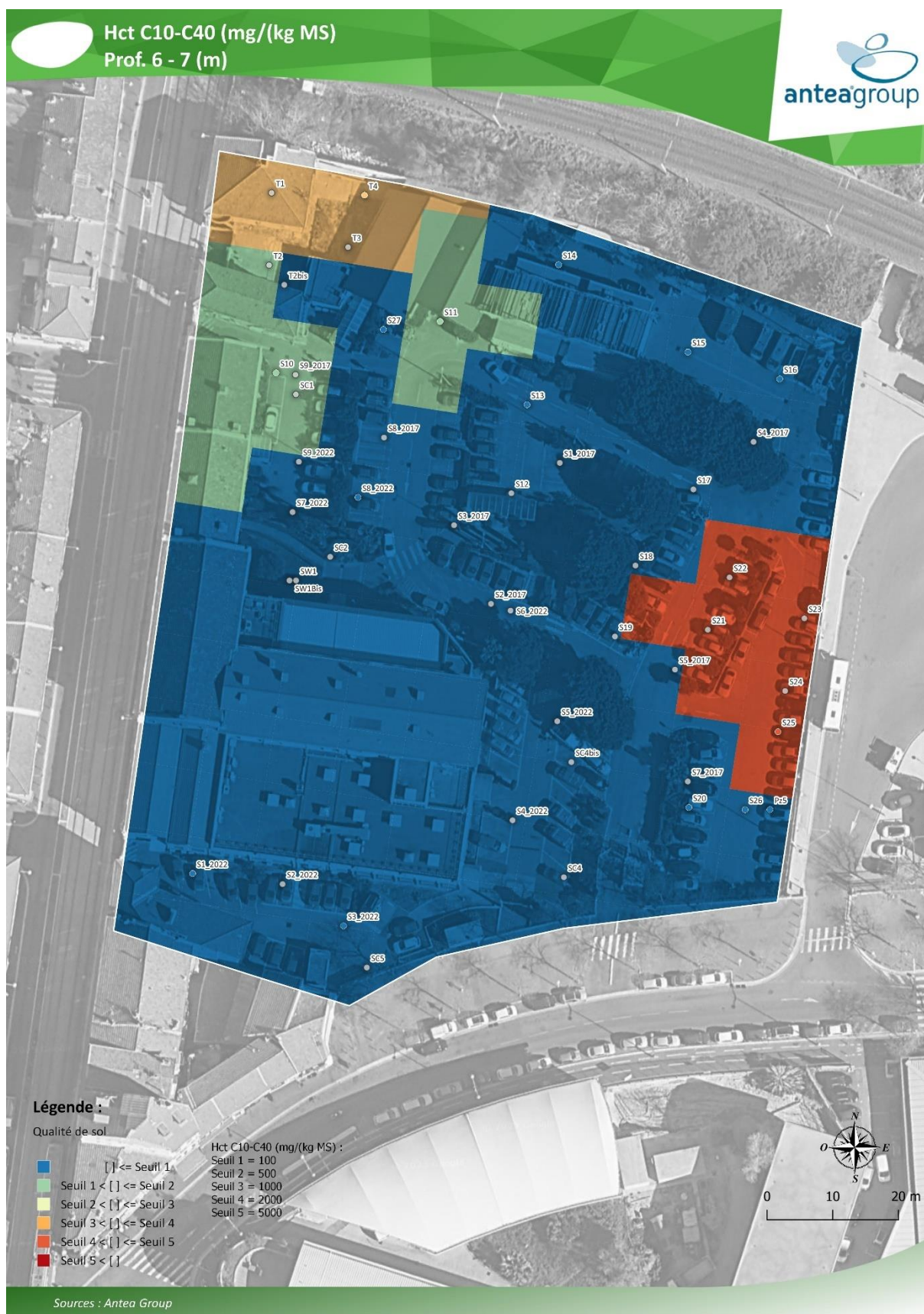
Figure 39 : Modélisations de l'impact en HCT dans les sols (données 2017, 2022 et 2023)
