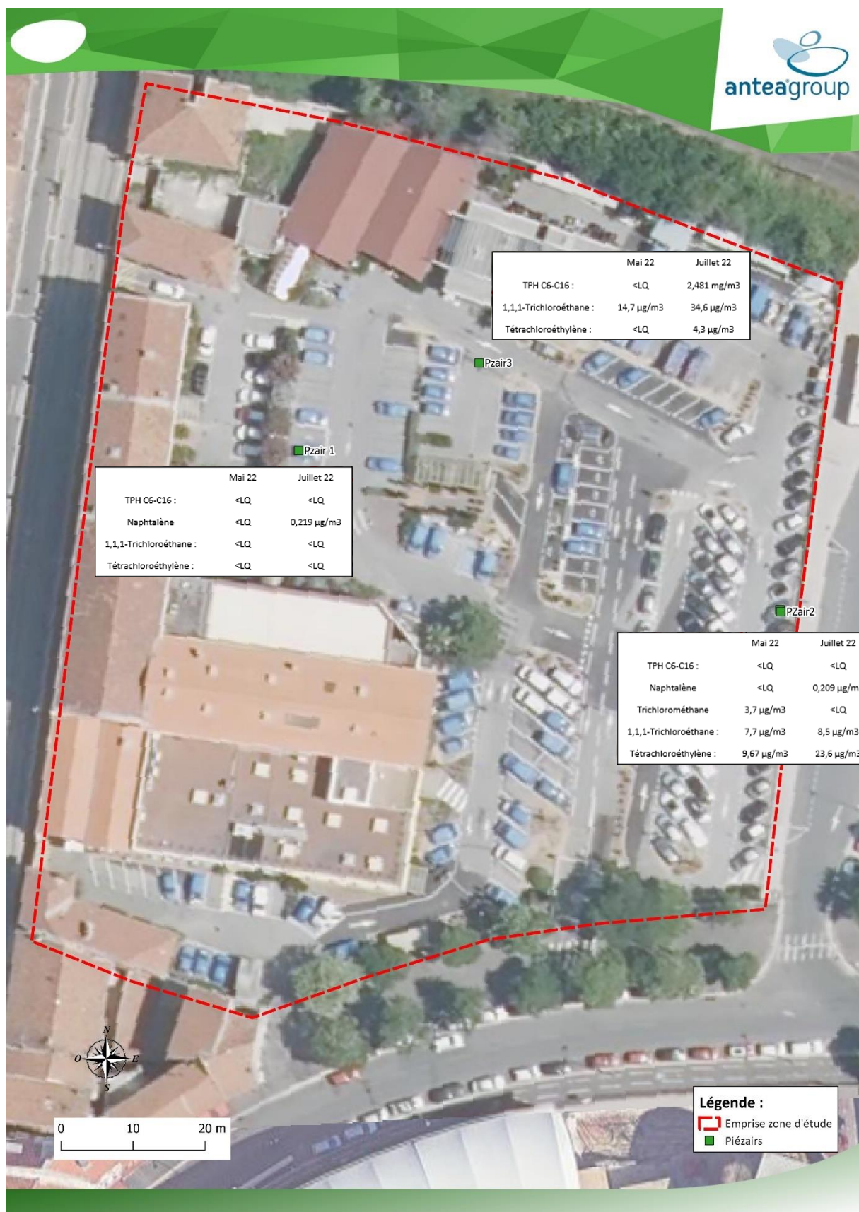
Figure 33 : Cartographie des teneurs quantifiées dans les gaz du sol
