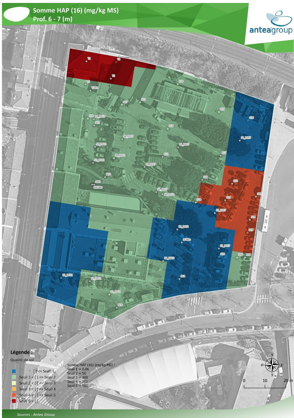
Figure 40 : Modélisations de l'impact en HAP dans les sols (données 2017, 2022 et 2023)
