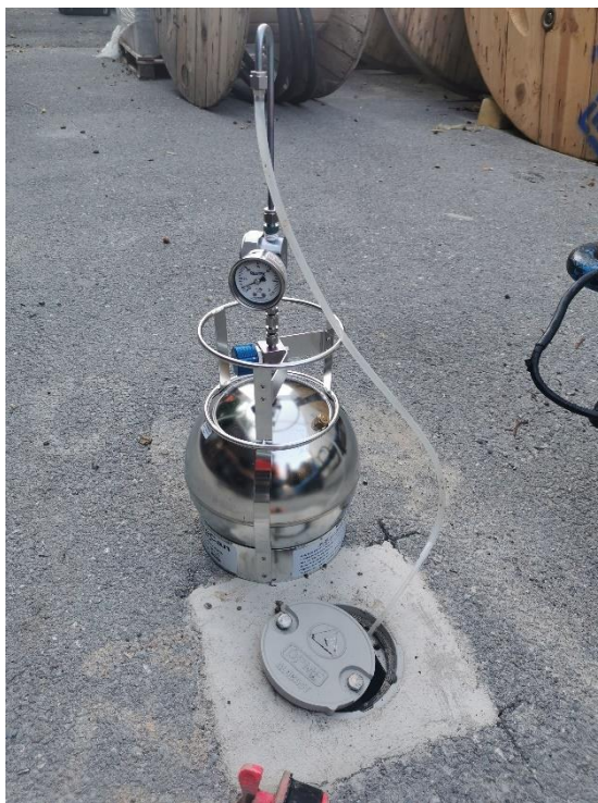
Figure 26 : Réalisation du prélèvement d'air (canister 6L) – Pz4
