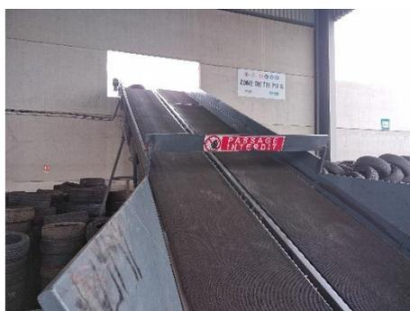
*Figure 10 : Convoyeur d'après tri*
