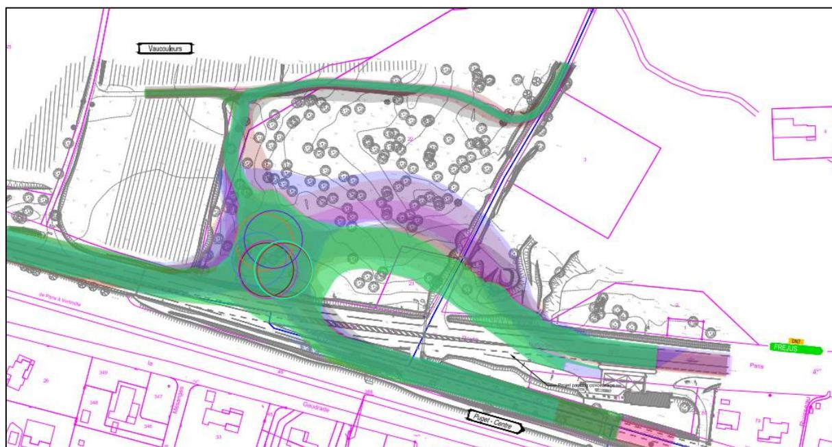
Superposition de l'ensemble des 9 version d'implantation du carrefour giratoire (solution retenue verte)
