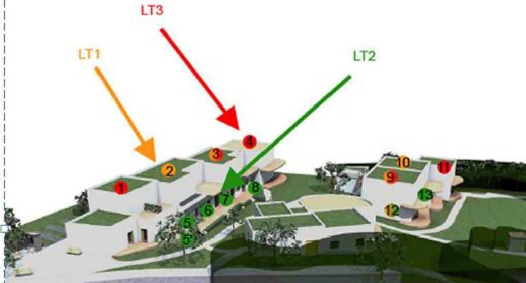
**Objectif** : STD partielle du projet, sur des logements tests (LT) de manière à évaluer les besoins en chauffage
