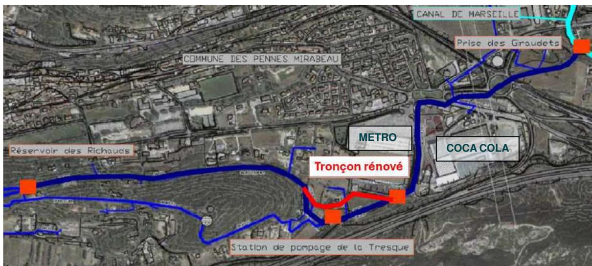
Le diagnostic a révélé des désordres importants, en particulier sur la génératrice supérieure de la canalisation avec des intrusions racinaires qui menacent directement l'intégrité de l'ouvrage. Compte tenu des enjeux de desserte en eau exposés ci-dessus, la rénovation de ce tronçon s'avère indispensable à court terme.
