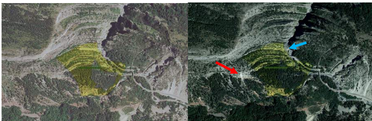
Figure 79. Evolution du site RNN 03 entre 2000 et 2012 (figures sédimentaires du Berriasien), la flèche rouge indique un petit éboulement récent en limite ouest de la parcelle classée RNN. La flèche bleue indique l'éboulement en bord de route (nettoyé), consolidé depuis par un mur en bord de route.
