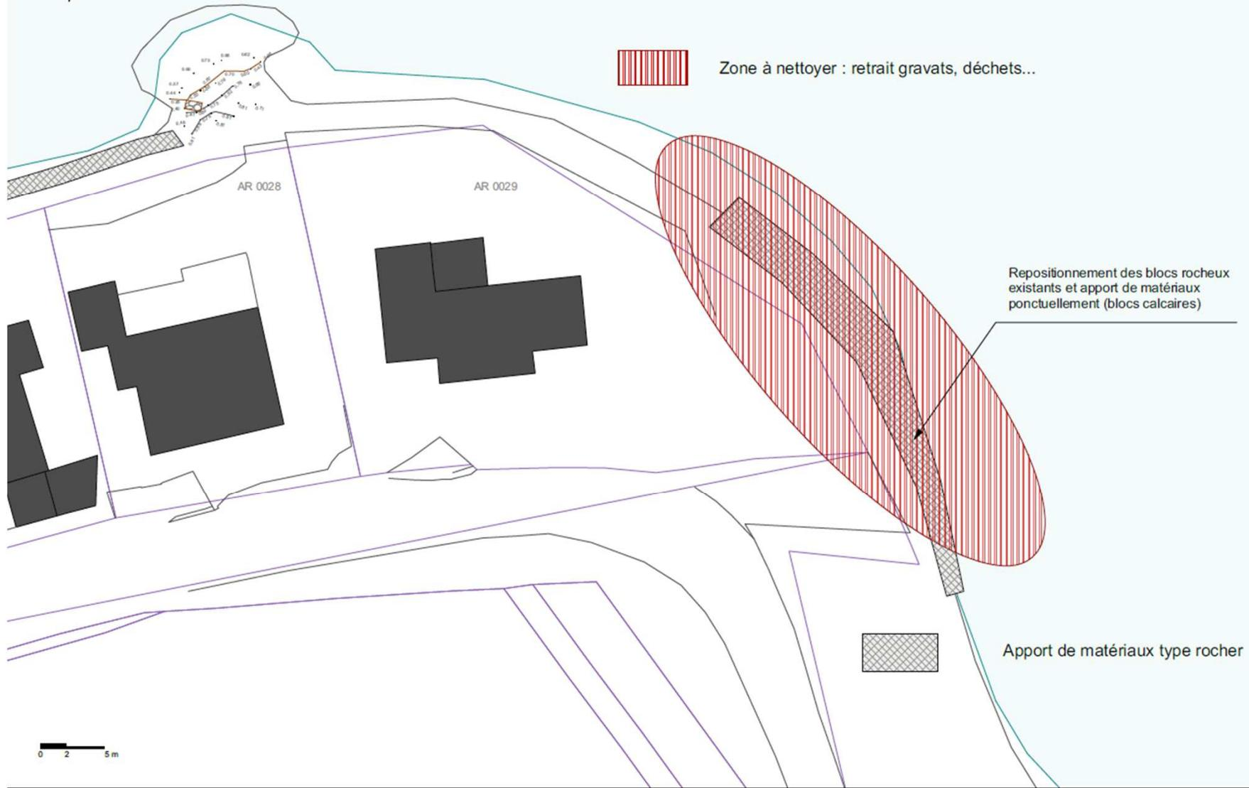
Repositionnement des blocs rocheux existants et apport de matériaux ponctuellement (blocs calcaires)
